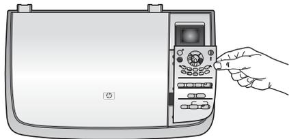
**a** コントロールパネル オーバレイをプリンタのコントロールパネルの上に重ねます。
