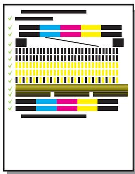
a コントロール パネルの各メッセージに対して **OK** を押し、プリント カートリッジの調整を開始します。
