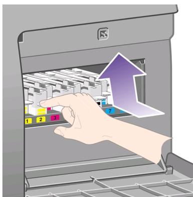
4. プリントヘッドクリーナを持ち上げてスロットから取り外し、下の図のように水平に取り出します。
