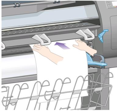
7. 下の図のように、用紙の先端がプリンタから出てくるまで挿入します。
