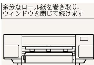
12. 用紙のたるんだ部分をロール紙に巻き直します。それには、ストッパを使用してロール紙を図の方向に回転させます。
