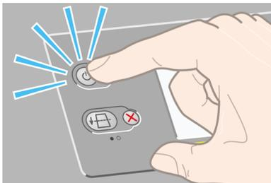
Al apagar la impresora de esta forma se evita que los cabezales de impresión se sequen, ya que se almacenan automáticamente con los limpiadores de cabezales.
