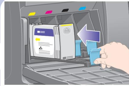
Vuelva a introducir el cajón del cartucho de tinta en la impresora hasta que éste encaje en su sitio.
