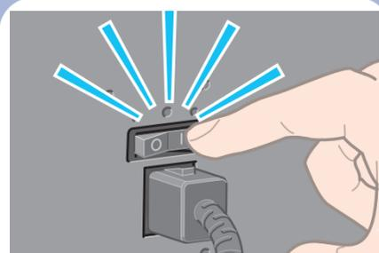
Ajuste el interruptor de la parte posterior de la impresora en la posición de encendido.
