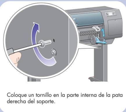
Coloque un tornillo en la parte interna de la pata derecha del soporte.
