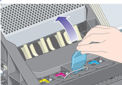
Levante la cubierta. De esta forma, podrá acceder a los cabezales de configuración.
