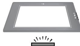
**Сторона обзора** (☜): Стекло на стороне сканирования очерчено светлой рамкой, на которую нанесен логотип HP и название продукта. Глядя на сторону обзора, можно через стекло видеть сканируемый материал. Во время сканирования лампа сканера светит в сторону, противоположную этой стороне. Отпечатки пальцев и пыль, оказавшиеся на стороне обзора, не оказывают влияния на качество результатов сканирования.
