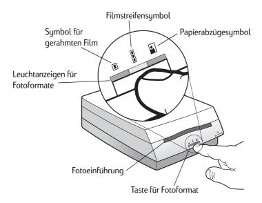
Um den Fotoscanner auf das richtige Fotoformat einzustellen, drücken Sie die Taste für Fotoformat, bis die Leuchtanzeige unter dem Symbol des gewünschten Fotoformats blinkt. Wie auf der folgenden Seite dargestellt, verändert sich die Größe der Fotoeinführung in Abhängigkeit vom gewählten Fotoformat.
