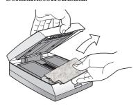
6. Schließen Sie die Fotoscanner-Abdeckung, indem Sie diese bis zum Einrasten nach unten drücken.
