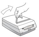
4. Halten Sie das untere Ende des Fotoscanners mit der einen Hand fest, und öffnen Sie die Scanner-Abdeckung mit der anderen Hand.
