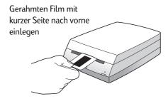
Schieben Sie den gerahmten Film langsam in die Einführung ein, bis die Scanner-Leuchtanzeige aufleuchtet und der Fotoscanner mit dem Einzug des gerahmten Films beginnt.
