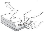
5. Öffnen Sie vorsichtig die Fotoscanner-Abdeckung, und entfernen Sie den Schaumstoffeinsatz.
