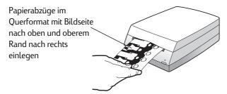
Bei Bildern im Hochformat muß der Papierabzug so ausgerichtet werden, daß sich der obere Rand des Papierabzugs beim Einlegen in die Fotoeinführung vorne befindet.
