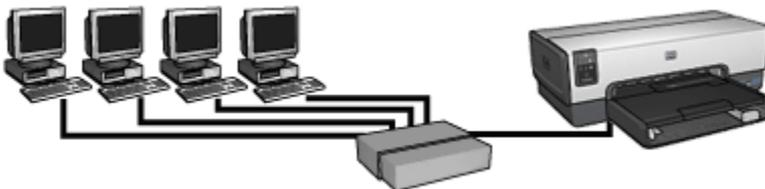
In diesem Beispiel werden die Netzwerkgeräte mit einem [Hub](#) verbunden. Die Geräte verwenden zum Abrufen von IP-Adressen [AutoIP](#).
