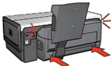
Hinweis: Drücken Sie beim Anbringen des Zubehörs am Drucker nicht die Tasten, die sich an beiden Seiten befinden. Verwenden Sie diese nur, wenn Sie das Zubehör vom Drucker entfernen.
