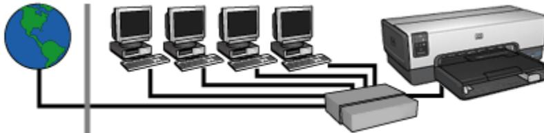
In diesem Beispiel verwaltet ein [Router](#) die Netzwerkverbindungen und dient als [Gateway](#) zwischen dem Netzwerk und dem Internet.
