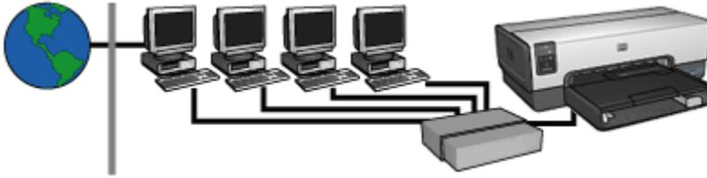
In diesem Beispiel werden die Netzwerkgeräte mit einem **Hub** verbunden. Ein Computer im Netzwerk dient als **Gateway** zwischen dem Netzwerk und dem Internet. Der Gateway-Computer verwendet **Windows Internet Connection Sharing (ICS)**, um die Netzwerkverbindungen zu verwalten und den anderen Geräten den Zugang zum Internet zu ermöglichen.
