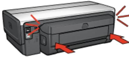
Hinweis: Drücken Sie beim Anbringen des Duplexers am Drucker nicht die Tasten, die sich an beiden Seiten befinden. Verwenden Sie diese nur, wenn Sie den Duplexer vom Drucker entfernen.
