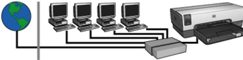
Dieses Beispiel ähnelt dem ersten Beispiel. In diesem Beispiel sind die Netzwerkgeräte jedoch an einen **Hub** und nicht an einen **Router** angeschlossen. Der Hub ist direkt mit dem Internet verbunden.
