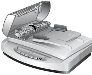
Heben Sie den grünen Hebel an, um die Transportwalzen freizulegen.
