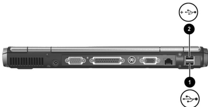
Gli hub USB si possono collegare a un connettore USB sul notebook, a un replicatore di porte opzionale o ad altri dispositivi USB. Gli hub supportano un numero variabile di dispositivi USB e vengono usati per aumentare il numero di dispositivi USB nel sistema. Gli hub alimentati devono essere collegati all'alimentazione esterna. Gli hub non alimentati devono essere collegati al connettore USB del notebook oppure a una porta su un hub alimentato.
