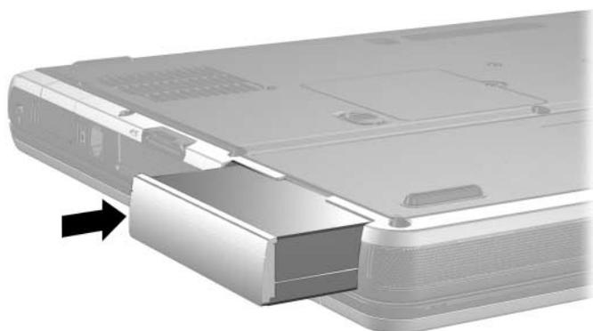
Per rimuovere una batteria, capovolgere il notebook. Far scorrere e tenere ferma la levetta di rilascio **1** mentre si estrae la batteria **2** dall'alloggiamento.
