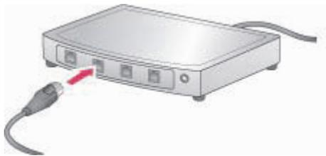
プリンタのネットワークへの接続を完了した後、プリンタ ソフトウェアをインストールします。ソフトウェアのインストールを行うまでは、コンピュータからの印刷はできません。
