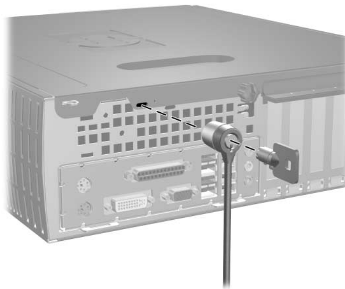
Ugradnja sigurnosne bravice
