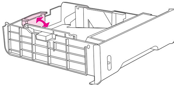
4. Atur pengarah lebar. Untuk kertas ukuran letter, tekan bagian tengah pengarah lebar sisi ke arah luar sejauh mungkin. Untuk kertas ukuran A4, tekan tonjolan biru, pada bagian luar pengarah lebar sisi, ke arah dalam sejauh mungkin.
