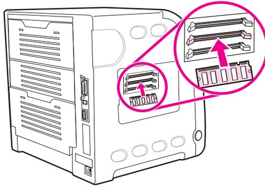
7. Tekan DIMM dengan kuat dan lurus hingga masuk ke dalam slot. Tutup pengunci di setiap sisi DIMM sampai terpasang dengan benar.
