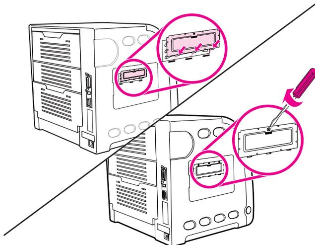
9. Pasang kembali pintu akses DIMM dengan memasukkan tab pada pintu ke dalam slot pada printer. Dorong pintu hingga tertutup.
