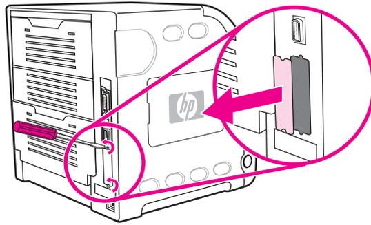
4. Masukkan dengan kuat kartu server cetak HP Jetdirect ke dalam slot EIO. Masukkan dan kencangkan sekrup penahan yang disertakan bersama kartu server cetak.
