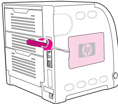
4. Buka sekrup yang menahan pintu pemasangan pada printer. Lepaskan pintu pemasangan.
