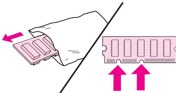
6. Pegang DIMM di bagian tepinya, sejajarkan lekukan pada DIMM dengan kisi-kisi yang berada dalam slot DIMM.
