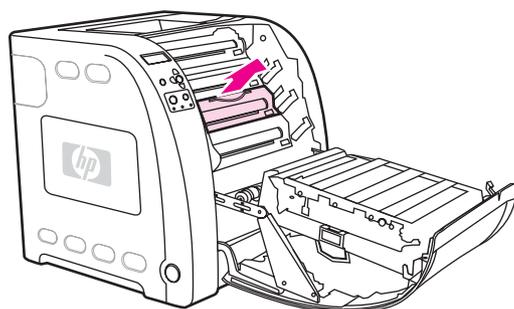
3. Keluarkan kartrid cetak yang baru dari kemasannya. Masukkan kartrid cetak bekas ke dalam kantung untuk didaur ulang.
