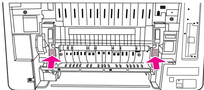
12. Untuk memasang kembali pintu belakang bawah (tempat hasil cetak belakang), tahan pintu pada kemiringan 45°, lalu masukkan pengait ke dalam lubang bulat pada sisi kanan.
