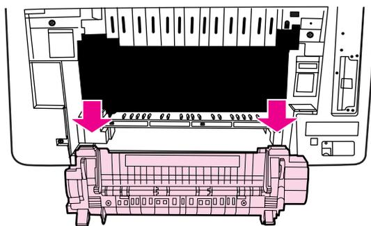
8. Pada fuser, tekan dan angkat tab hitam untuk membuka pintu penutup.
