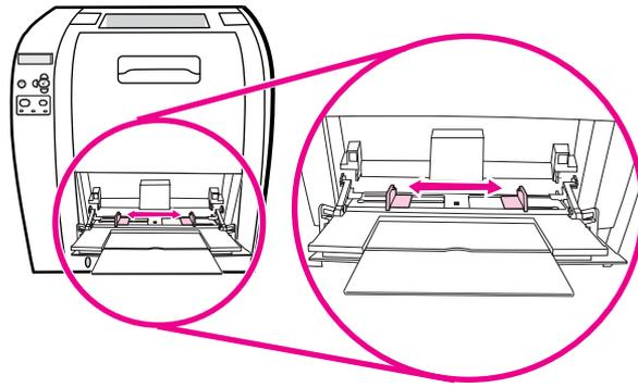
4. Masukkan hingga 10 amplop ke tengah Baki 1 dengan muka cetak menghadap ke atas dan area peranko mendekati printer serta tepi pendek mengarah ke printer. Geser amplop ke dalam printer sejauh mungkin tanpa memaksanya.
