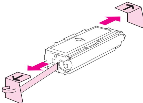
6. Sejajarkan kartrid cetak pada jalur di dalam printer dan dengan menggunakan pegangannya, masukkan kartrid cetak hingga terpasang dengan benar.
