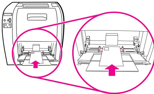
5. Atur pengarah agar menyentuh tumpukan amplop tanpa membuatnya mengerut. Pastikan amplop berada di bawah tab pengarah.
