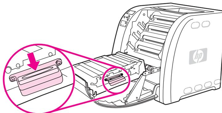
3. Pegang pegangan biru sebelah kiri lalu angkat untuk mengeluarkan unit transfer dari printer.
