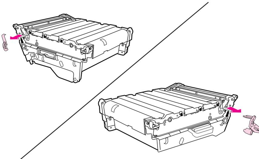
6. Arahkan sisi kiri unit transfer ke dalam pintu depan printer. Masukkan kedua pengait pada sisi kiri ke dalam lubang, kemudian rendahkan sisi kanan ke dalam pintu.
