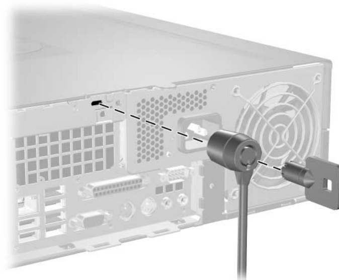
Инсталиране на кабелна ключалка
