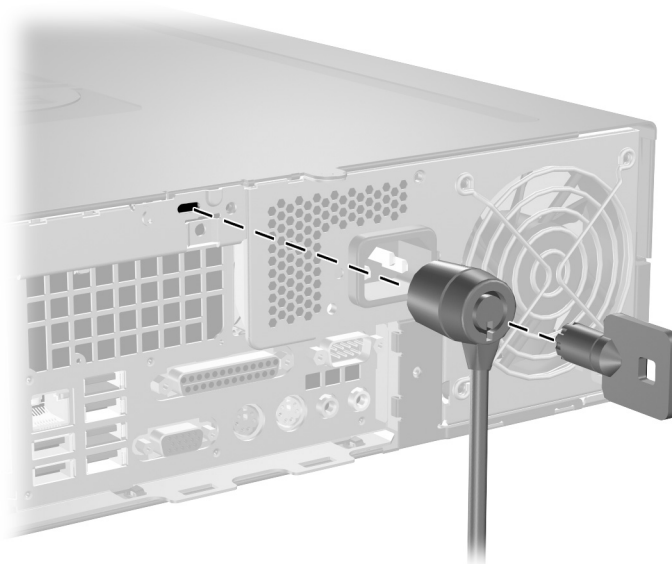
Installation d'un câble de sécurité
