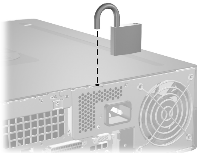
Installation d'un cadenas
