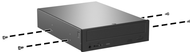
Installation des vis de guidage sur l'unité optique
