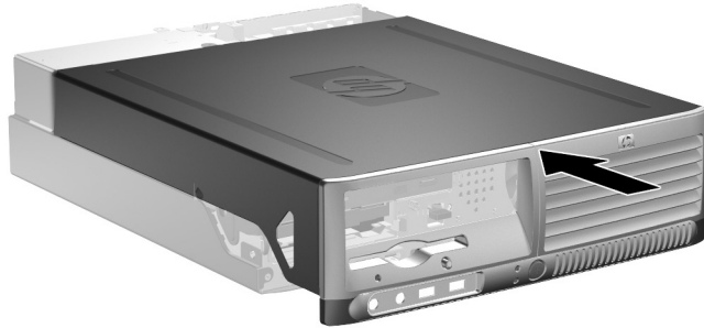
Reemplazo de la Cubierta de la Computadora
