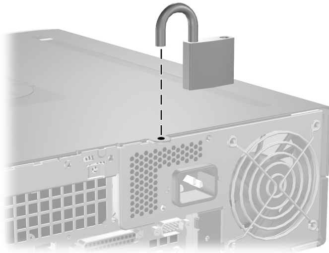
Instalación de un Candado
