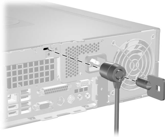
Instalación de un Bloqueo de Cable
