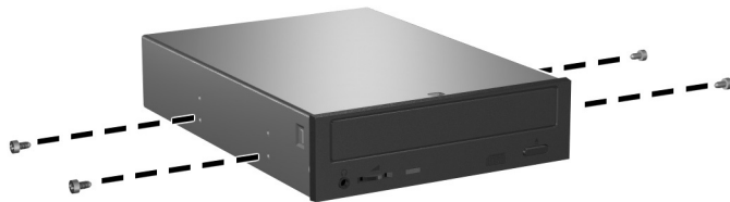
Instalación de Tornillos Guía en la Unidad Óptica
