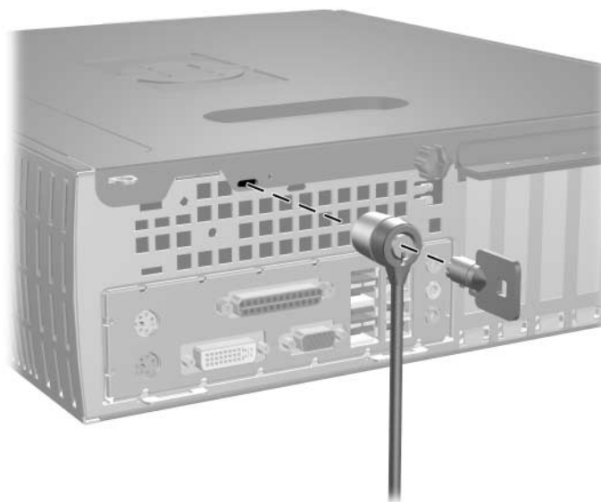
Inštalácia lankového zámku
