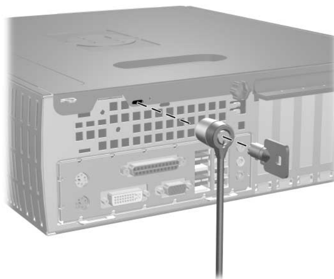
Installere en kabellås
