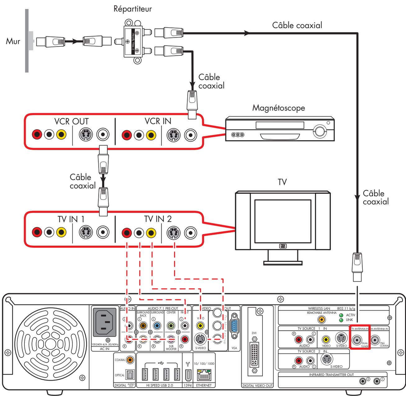
Prise murale au magnétoscope et au téléviseur avec un câble coaxial (ajouter la platine HP Digital Entertainment Center à l'aide d'un répartiteur)
