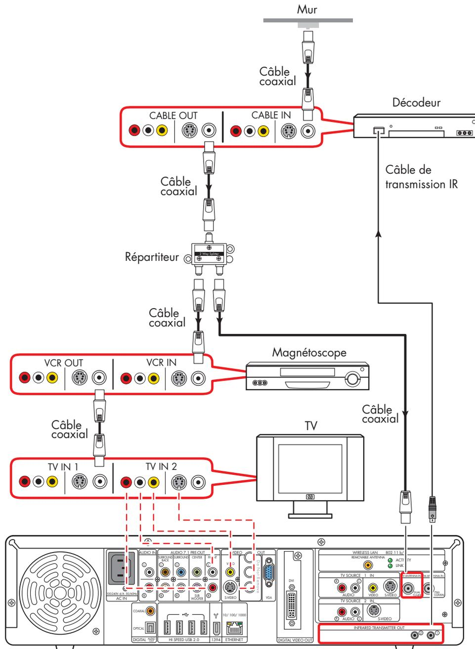
**Prise murale au boîtier décodeur de réception, au magnétoscope et au téléviseur avec un câble coaxial (avec répartiteur)**
