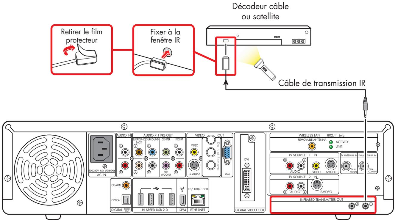
**Connexion du câble de transmission infrarouge à un décodeur câble, satellite ou numérique**
