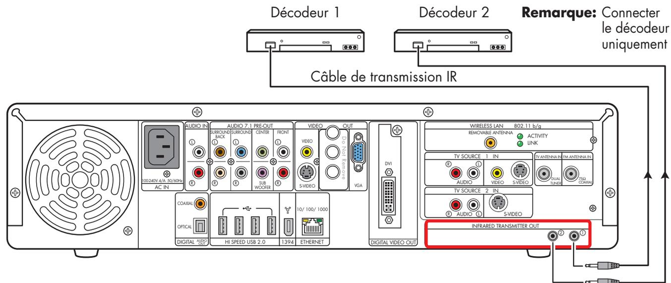
**Connexion du câble de transmission infrarouge (deux décodeurs, certains modèles uniquement)**
