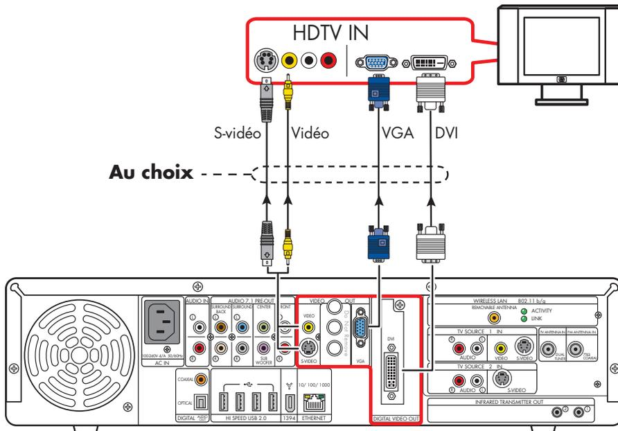
**De la sortie vidéo à un téléviseur haute définition HDTV**
