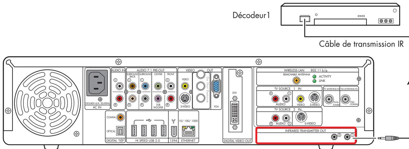
**Connexion du câble de transmission infrarouge (un seul décodeur)**
