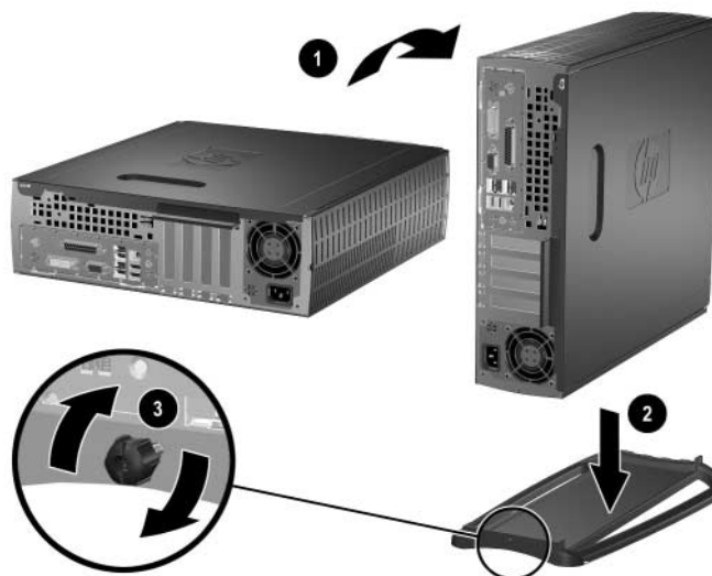
Installatie van de towerstandaard
