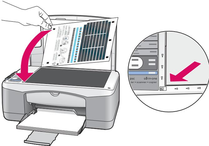
Nach dem Einsetzen der Patronen wird eine Druckpatronen-Ausrichtungsseite gedruckt. (Die Ausrichtung kann einige Minuten dauern.)
