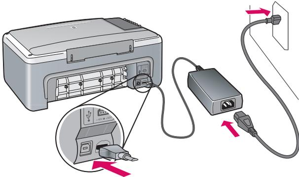
**Wichtig:** Schließen Sie das USB-Kabel erst an, wenn im weiteren Verlauf dieses Einrichtungshandbuchs die entsprechende Anweisung erteilt wird.
