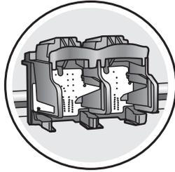
Öffnen Sie die Zugangsklappe bis zum Anschlag. Stellen Sie sicher, dass der Druckpatronenwagen in die Mitte fährt.
