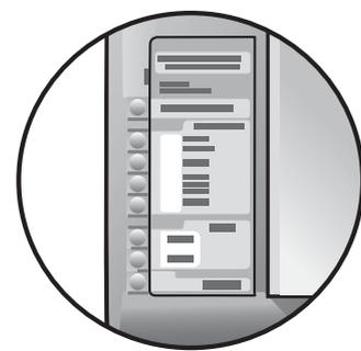
**d** Befestigen Sie die Schablone durch festes Andrücken. Üben Sie keinerlei Druck auf den LCD-Bereich aus. Die Laschen müssen sich in den Aussparungen befinden.
