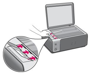
蓋を開きます。オーバレイのタブをプリンタに 差し込みます。オーバレイをプリンタに取り付ける前に、タブが正しく差し込まれていることを確認します。
