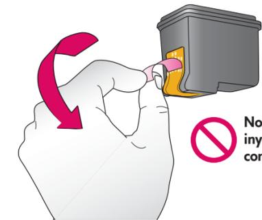
**No toque ni retire los inyectores de tinta ni los contactos de color cobre**
