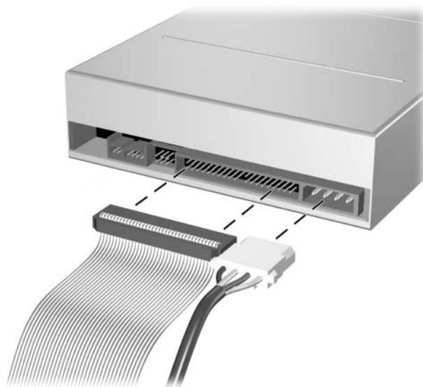
Anslutning av ström- och datakablarna
