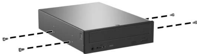
オプティカルドライブへのガイド用ネジの取り付け
