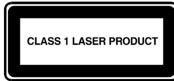
이 라벨은 해당 제품이 Class 1 레이저 제품으로 분류됨을 나타냅니다. 이 라벨은 제품에 설치된 레이저 장치 위에 표시되어 있습니다.
