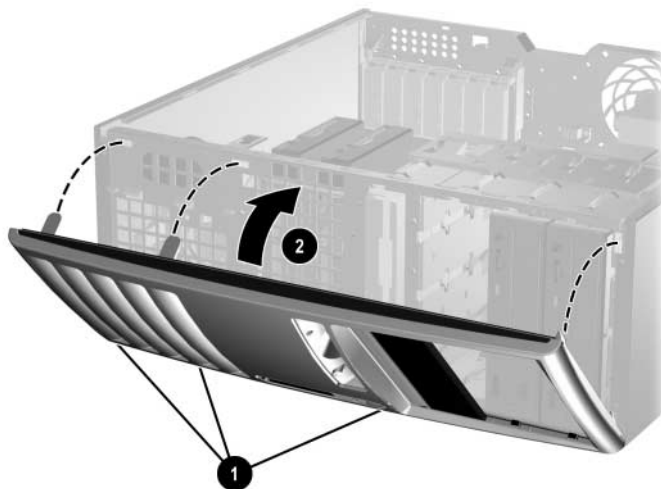
Επανατοποθέτηση της πρόσοψης
