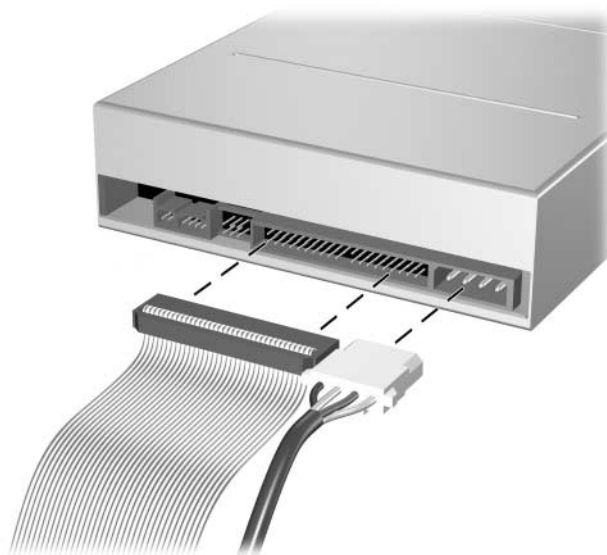
A tápkábel és az adatkábel kihúzása
