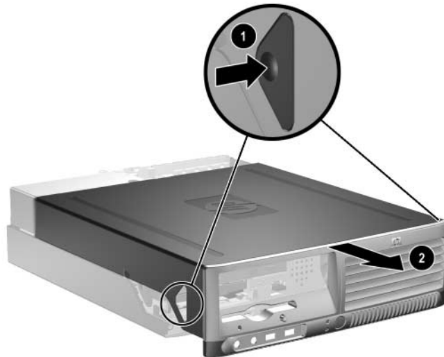
A számítógép fedelének eltávolítása
