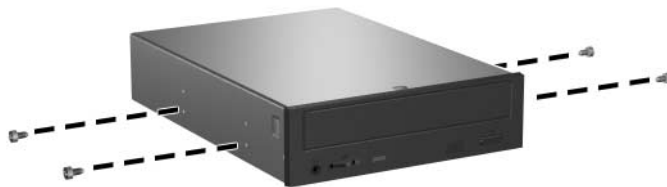
Tartócsavarok felszerelése az optikai meghajtóra
