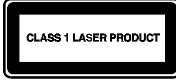
Bu etiket, ürünün 1. SINIF LAZER ÜRÜNÜ olarak sınıflandırıldığını gösterir. Bu etiket ürün takılı lazer aygıtı üzerinde görünür.
