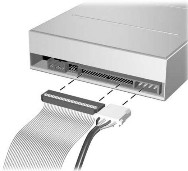
Připojení napájecího kabelu a datových kabelů
