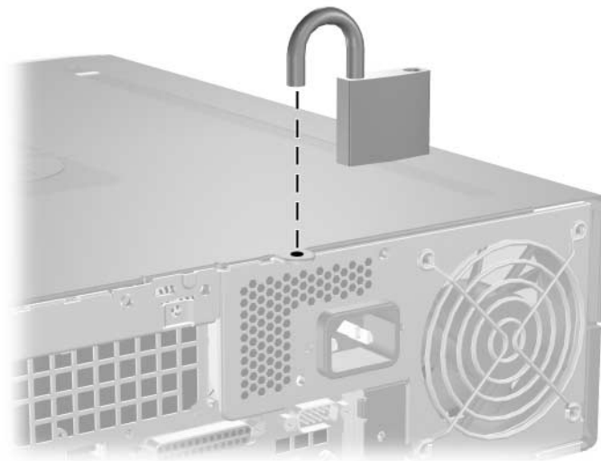
Instalace visacího zámku
