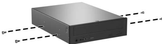
Instalace vodících šroubů do optické jednotky
