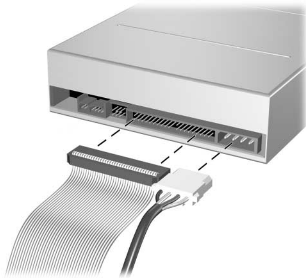
Abziehen der Strom- und Datenkabel
