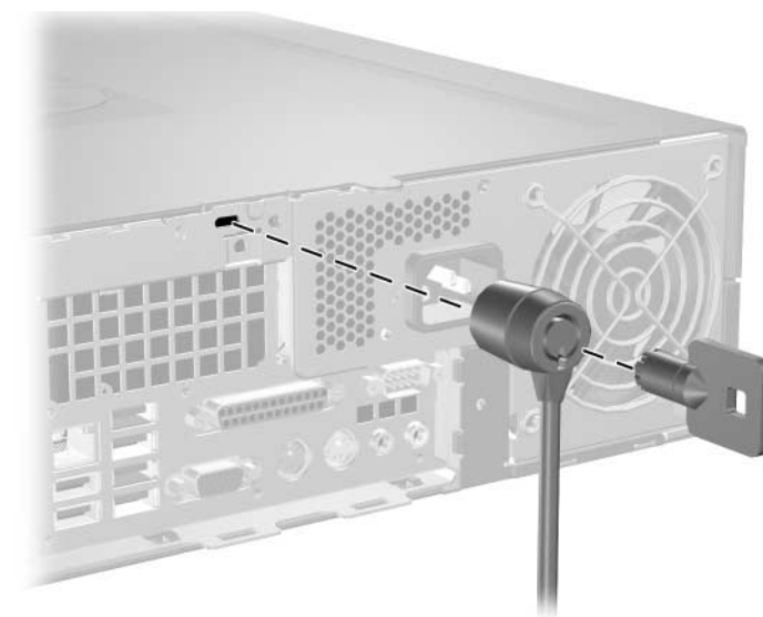
Anbringen eines Kabelschlosses
