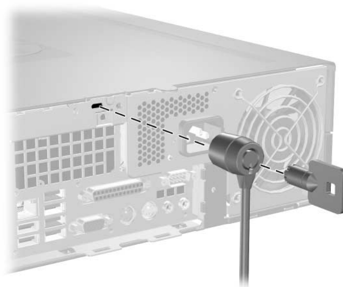
Ugradnja sigurnosne bravice
