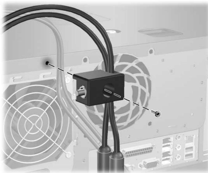
4. Inserire l'estremità del cavo di sicurezza nel dispositivo di blocco ❶ e premere il pulsante ❷ per chiudere il dispositivo. Per aprire il dispositivo di blocco, servirsi della chiave in dotazione.
