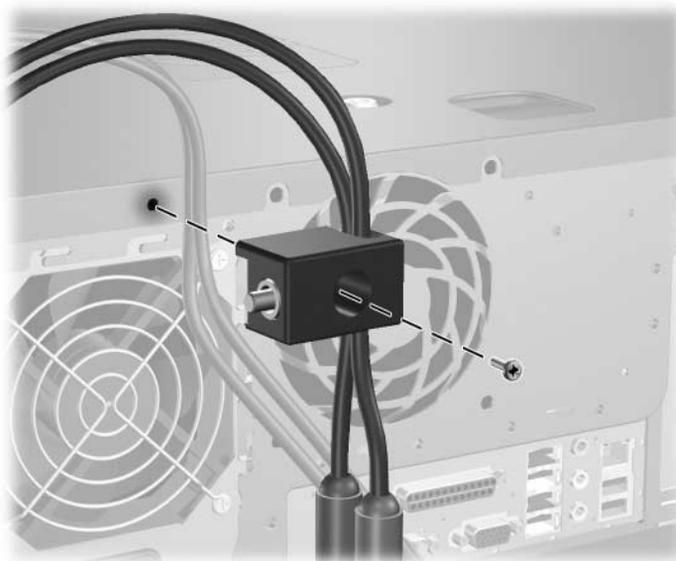
3. Inserire il connettore nel dispositivo di blocco ❶ e premere il pulsante ❷ per impegnare il dispositivo di blocco. Per aprire il dispositivo di blocco, servirsi della chiave in dotazione.
