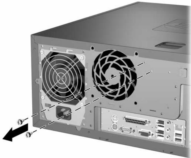
*Rimozione delle viti della chiusura Smart Cover*
