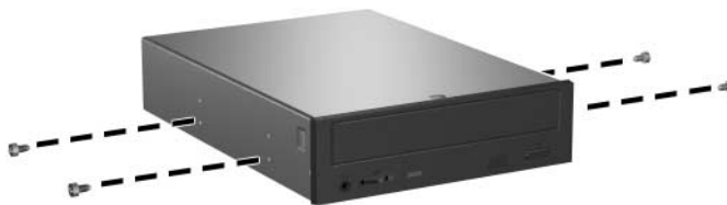
Prisukamųjų varžtų įsukimas į optinių diskų įrenginį
