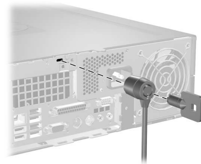
Kabeļa slēdzenes uzstādīšana
