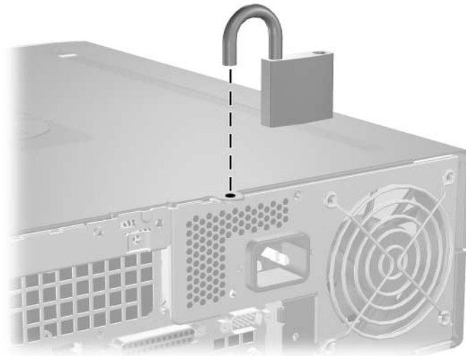
Piekaramās slēdzenes uzstādīšana
