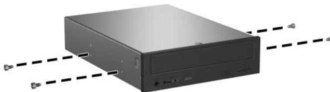
Vadskrūvju ieskrūvēšana optiskajā diskdziņī
