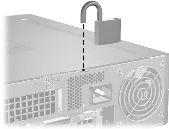
Instalarea unui lacăt
