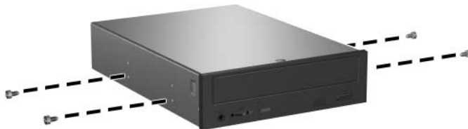
Установка направляющих винтов дисковода оптических дисков
