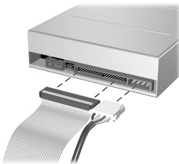
Отсоединение кабелей питания и сигнальных кабелей
