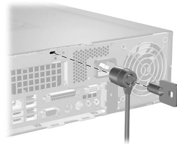
Установка замка с тросиком
