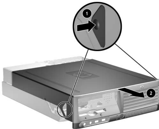
Снятие крышки компьютера
