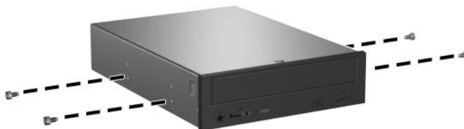
Pritrditev vodilnih vijakov na optični pogon
