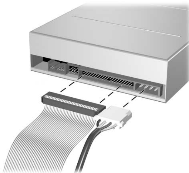
Priključitev napajalnega in podatkovnega kabla
