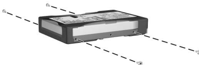
Instalacija vodećih šrafova za čvrsti disk
