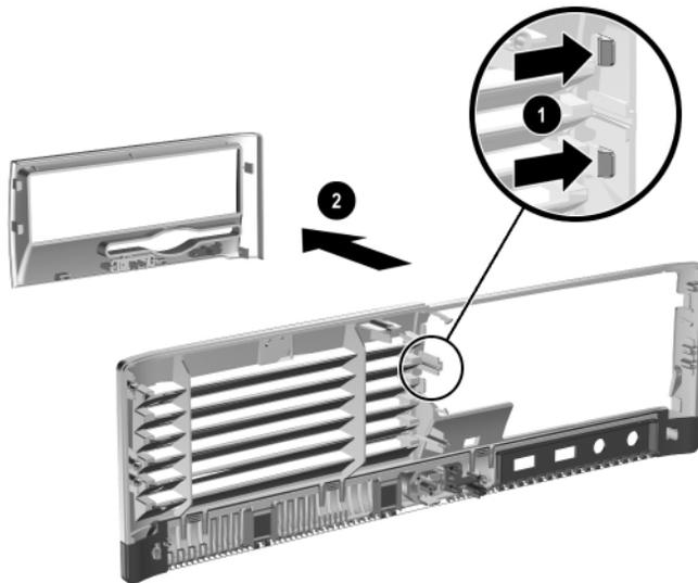
*Extracción del panel de la unidad (se muestra el panel de una unidad de disquete)*
