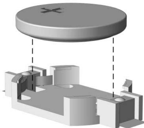
*Extracción de una batería tipo botón (Tipo 1)*
