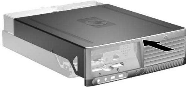
*Colocación de la cubierta del equipo*
