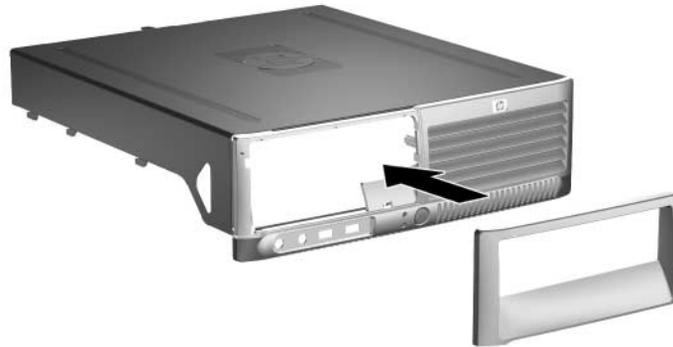
*Instalación del panel de una unidad (se muestra un panel para una unidad de disco duro)*
