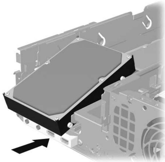
*Instalación de una unidad en un compartimiento para unidad de 3,5 pulgadas (se muestra una unidad de disco duro)*
