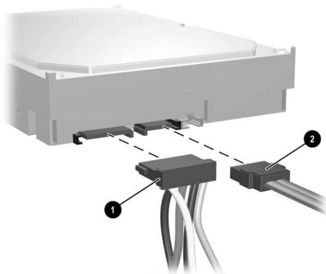
*Desconexión de los cables de alimentación y de datos de la unidad de disco duro*
