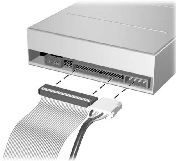
*Desconexión de los cables de alimentación y de datos*
