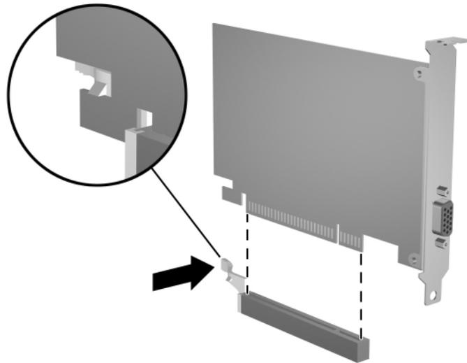
*Extracción de una tarjeta de expansión PCI Express x16*
