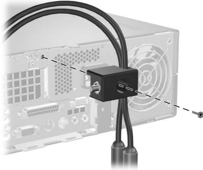
4. Inserte el extremo del tapón del cable de seguridad en el candado ❶ y empuje el botón hacia dentro ❷ para acoplar el candado. Utilice la llave provista para desacoplar el candado.
