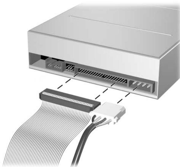
*Conexión de los cables de alimentación y de datos*
