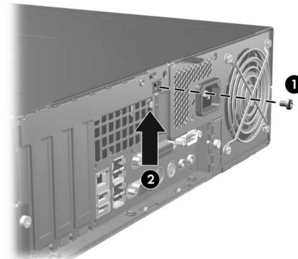
*Extracción del tornillo del bloqueo de Smart Cover*
