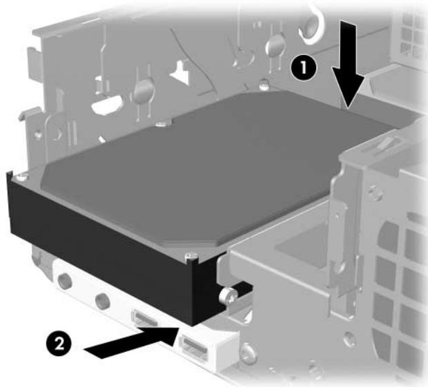
*Instalación de una unidad en un compartimento para unidad de 3,5 pulgadas (se muestra una unidad de disco duro)*
