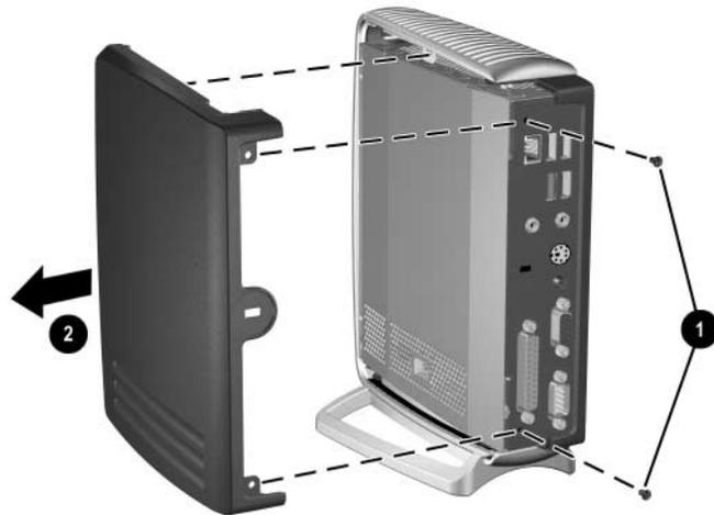
側面のアクセス パネルの取り外し
