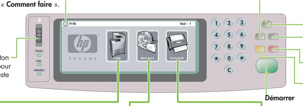
Utilisez ce bouton de luminosité pour régler le contraste du panneau de commande.
