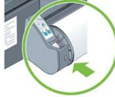
7. Führen Sie die Vorderkante des Papier bis zum Anschlag in den Schacht der hinteren Zufuhr des Druckers ein. Achten Sie darauf, dass die Seiten des Papiers fest aufgerollt bleiben, damit das Papier richtig ausgerichtet ist.
