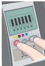
2. Ziehen Sie die Rolle in Ihre Richtung, und entfernen Sie das Papier vollständig aus dem hinteren Pfad des Druckers. Die unten gezeigten Symbole blinken, bis kein Papier mehr im Drucker ist. Wenn das Papier nur teilweise entfernt wird, kann es vermehrt zu Papierstaus kommen. Manchmal kann das Papier auch von selbst aus dem hinteren Pfad herausfallen.
