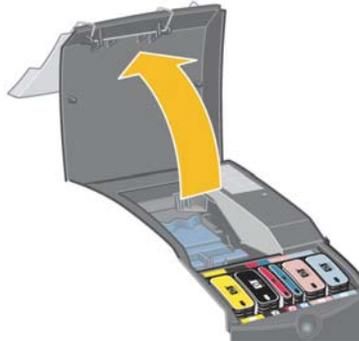
4. Klappen Sie oben am Druckkopf den kleinen Griff hoch, und ziehen Sie damit den Druckkopf senkrecht nach oben aus dem Drucker heraus.
