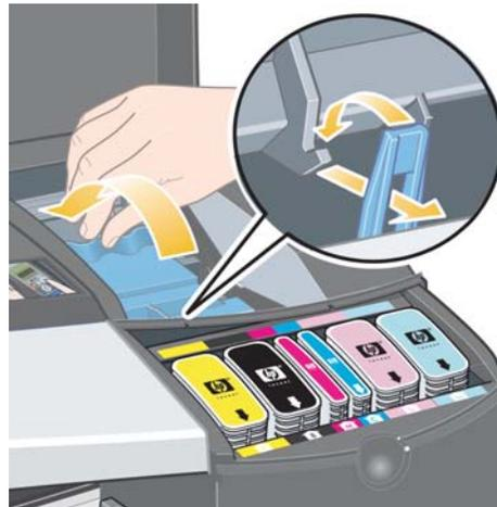
6. Schließen Sie zuerst den hinteren und dann den vorderen Teil der Klappe. Nachdem Sie die Klappe geschlossen haben, führt der Drucker automatisch interne Kalibrierungen mit dem Druckkopf und danach die Ausrichtung aus. Während der Ausrichtung muss sich Papier im Fach befinden (Sie können das günstigste Papier verwenden). Kalibrierungen vor der Ausrichtung sind zeitintensiv, besonders wenn mehrere Druckköpfe ausgewechselt wurden.
