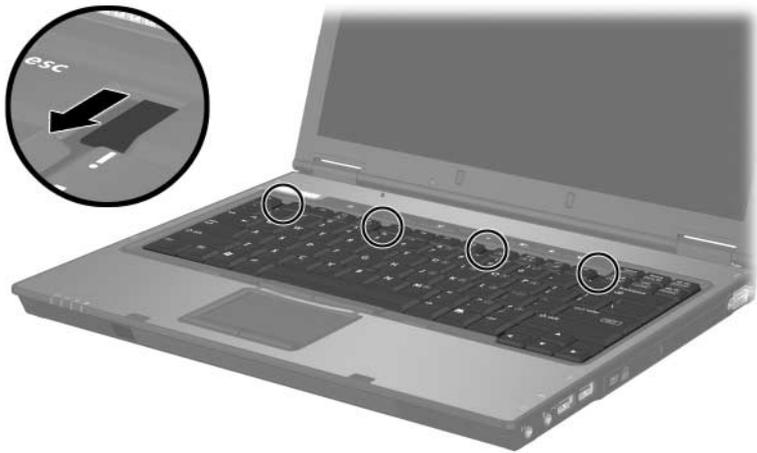
9. Levante el borde superior del teclado e incline el teclado hasta que se apoye en el reposamuñecas del ordenador portátil.
