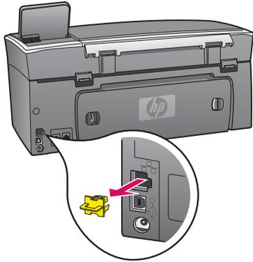
**a** Retire el cable amarillo de la parte trasera del dispositivo.
