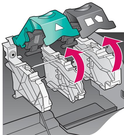
**a** Поднимите крышку доступа.
