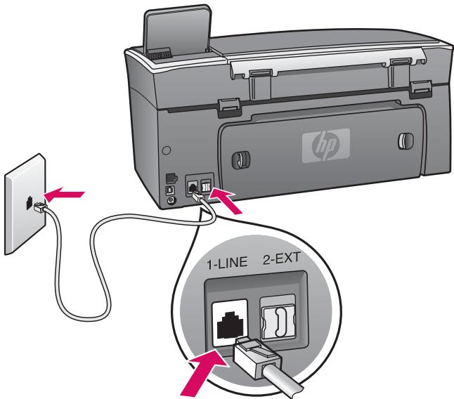
Подсоедините один конец прилагаемого телефонного кабеля к порту для телефона (1-LINE) (ЛИНЕЙНЫЙ 1), а другой - к стенной розетке.
