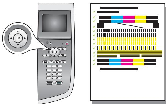
**а** Нажмите кнопку **OK** при каждом запросе на панели управления, чтобы начать юстировку картриджа.
