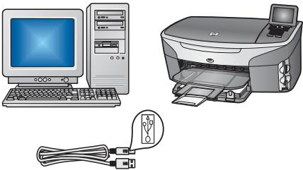
Используйте этот тип соединения, если необходимо подключить аппарат непосредственно к одному компьютеру (**не выполняйте соединения, пока соответствующее указание не появится в программном обеспечении**).
