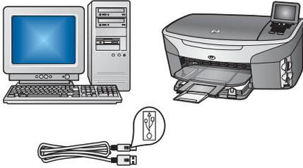
Utilize esse tipo de conexão se desejar conectar o dispositivo diretamente a um computador. **(Não conecte até que o software o instrua a fazê-lo.)**
