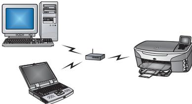
Utilize esse tipo de conexão se desejar uma conexão sem fio (802.11 b ou g) entre o dispositivo e a rede.
