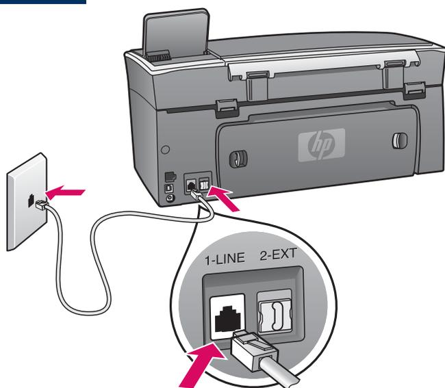
Conecte uma extremidade do fio telefônico fornecido à porta de telefone à esquerda **1-LINE** (LINHA-1) e a outra a uma tomada telefônica.
