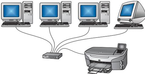
Utilize esse tipo de conexão se desejar uma conexão por cabo Ethernet entre o dispositivo e a rede.
