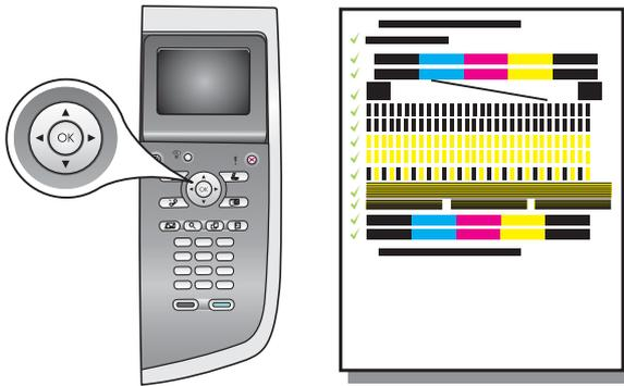
**a** 在控制面板的每個提示中按「OK」開始校正列印墨匣。
