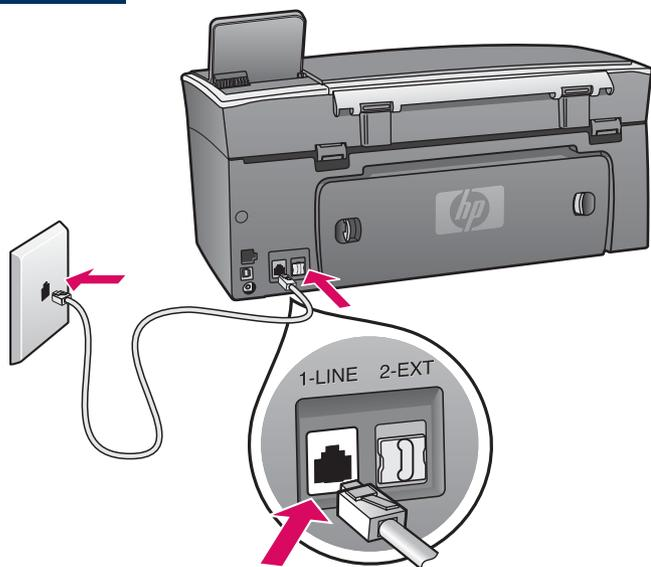
將提供的電話線一端連接到左側 **(1-LINE)** 上的電話連接埠，另一端連接到牆壁上的插孔。
