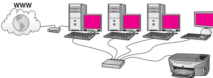
Dans cet exemple, les périphériques réseau sont connectés à un commutateur ou un routeur et un modem (connecté à l'ordinateur sur la gauche dans cette illustration). Le modem quant à lui est connecté à l'ordinateur grâce à un cordon et à une prise téléphoniques. Un seul ordinateur dispose de l'accès à Internet. Ni l'appareil tout-en-un HP ni les autres ordinateurs du réseau n'ont accès à Internet. Si telle est votre
