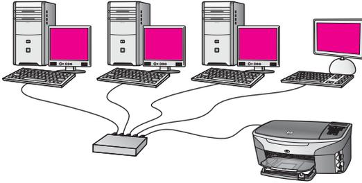
In dit voorbeeld is de netwerkapparatuur aangesloten op een switch of router en is er geen Internet-verbinding. De aangesloten apparaten maken gebruik van AutoIP, zodat de IP-adressen automatisch worden aangemaakt. Als u een dergelijke configuratie hebt, sluit u de HP all-in-one met een Ethernet-kabel aan op de switch of router. Zie [Aansluiten via een Ethernet-kabel](#) voor instructies over het aansluiten.
