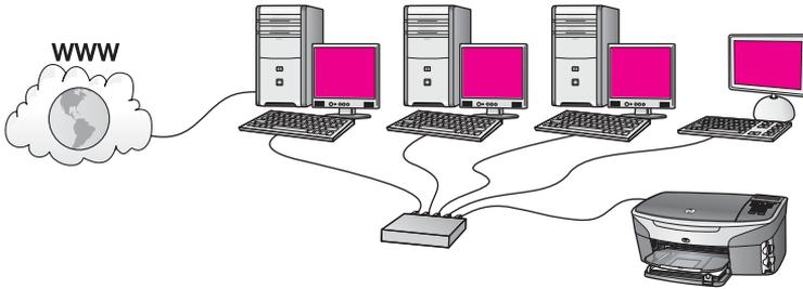
In dit voorbeeld is de netwerkkapparatuur aangesloten op een switch of router. Een van de netwerkcomputers fungeert als gateway tussen het netwerk en het Internet. De gatewaycomputer gebruikt Windows ICS (Internet Connection Sharing) of vergelijkbare software om de netwerkverbindingen te beheren en de andere apparaten toegang tot het Internet te geven.
