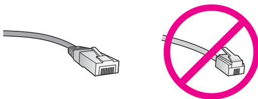
Bien que les câbles Ethernet classiques ressemblent fort aux câbles téléphoniques, ils ne sont pas interchangeables. Chacun contient un nombre différent de fils et chacun possède un connecteur distinct. Un connecteur de câble Ethernet (également appelé connecteur RJ-45) est plus large et plus épais
