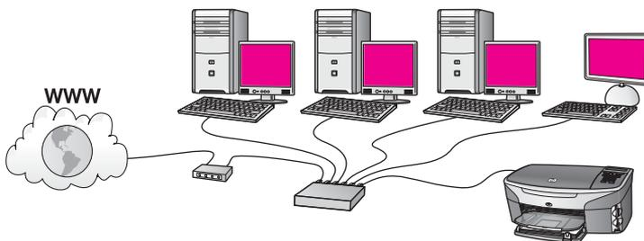
Dans cet exemple, un routeur gère les connexions réseau et un modem DSL ou un modem câble fournit l'accès à Internet. Si telle est votre configuration, connectez votre appareil tout-en-un HP au routeur au moyen d'un câble Ethernet.
