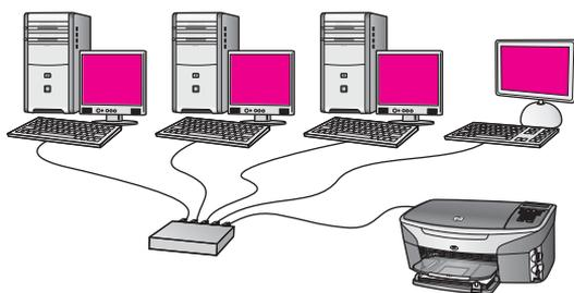
Dans ce cas de figure, les périphériques réseau sont connectés à un commutateur ou un routeur et il n'existe pas de connexion à Internet. Les périphériques utilisent AutoIP, ce qui implique que les adresses IP sont configurées de manière automatique. Si telle est votre configuration, connectez votre appareil tout-en-un HP au commutateur ou au routeur au moyen d'un câble Ethernet. Pour obtenir des instructions sur la connexion, reportez-vous à la section [Connexion via un câble Ethernet](#).
