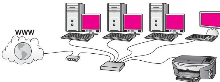
In dit voorbeeld worden de netwerkverbindingen geregeld door een router en biedt DSL of kabel toegang tot het Internet. Als u een dergelijke configuratie hebt, sluit u de HP all-in-one met een Ethernet-kabel aan op de router.
