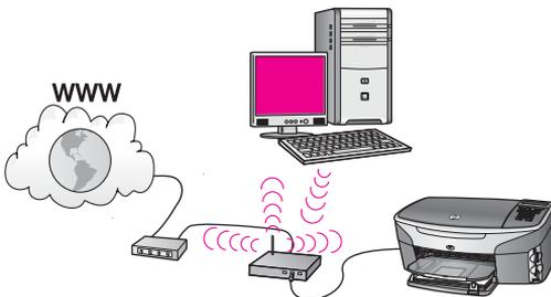
Het toegangspunt verbindt een bekabeld apparaat met een draadloos netwerk. In dit model wordt de computer via een draadloze netwerkadapter geconfigureerd voor draadloze netwerken en verzendt en ontvangt de computer gegevens via het toegangspunt. De HP all-in-one wordt geconfigureerd voor kabelnetwerken en is via een Ethernet-kabel aangesloten op het toegangspunt. Een DSL- of kabelmodem kan
