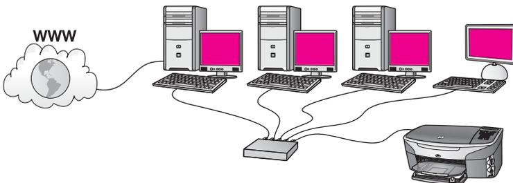
Dans cet exemple, les périphériques réseau sont connectés à un commutateur ou un routeur. Sur le réseau, un ordinateur sert de passerelle entre le réseau et Internet. L'ordinateur passerelle utilise le partage de connexion Internet (ICS) de Windows ou un autre logiciel similaire, pour gérer les connexions réseau et fournir un accès à Internet aux autres périphériques.
