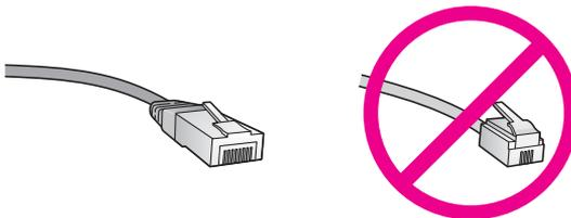
Hoewel standaard Ethernet-kabels veel lijken op standaard telefoonkabels, kunt u geen telefoonkabels gebruiken. Het aantal draden en de aansluiting van de twee soorten kabels verschilt. Een Ethernet-kabelaansluiting (ook wel een RJ-45-aansluiting genoemd) is breder en dikker en heeft altijd acht contactjes bij het uiteinde. Een telefoonaansluiting heeft twee tot zes contactjes.
