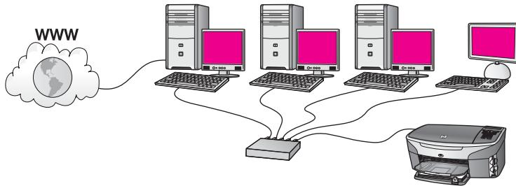
En este ejemplo, los dispositivos de la red están conectados a un conmutador o enrutador. Un equipo de la red funciona como pasarela entre la red e Internet. Este equipo utiliza la conexión compartida a Internet (ICS) de Windows o software similar para gestionar las conexiones de red y ofrecer acceso a Internet a los demás dispositivos.
