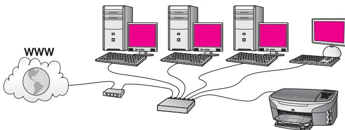
Neste exemplo, um roteador gerencia as conexões de rede, e um modem DSL ou a cabo fornece acesso à Internet. Se você utilizar esta configuração, conecte o HP all-in-one ao roteador com um cabo Ethernet.
