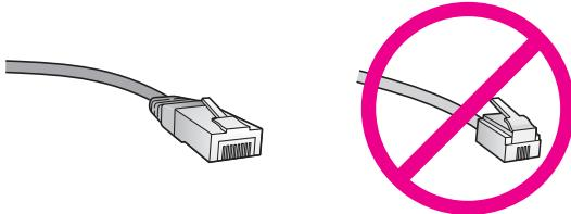
Apesar dos cabos padrão Ethernet parecerem similares aos cabos telefônicos, eles não são equivalentes. Há uma diferença na quantidade de fios e cada um deles utiliza um conector diferente. Um cabo conector Ethernet (também conhecido como conector RJ-45) é mais largo e alto na extremidade e sempre tem 8 contatos. Um conector telefônico tem entre 2 e 6 contatos.
