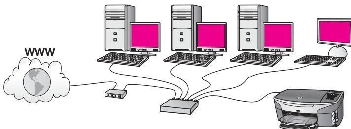
En este ejemplo, un enrutador gestiona las conexiones de la red y un módem DSL o de cable proporciona acceso a Internet. Si utiliza esta configuración, conecte el HP all-in-one al enrutador con un cable Ethernet.
