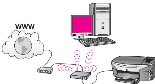
Seu ponto de acesso conecta um dispositivo com fio a uma rede sem fio. Neste modelo, seu computador é configurado para rede sem fio utilizando um adaptador de rede sem fio e transfere e recebe dados através do ponto de acesso. Seu HP all-in-one está configurado para rede com fio e está conectado ao ponto de acesso com um cabo Ethernet. Um modem a cabo ou DSL pode fornecer acesso à Internet. Para instruções sobre conexão, consulte [Como conectar com um cabo Ethernet](#).
