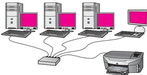
En este ejemplo, los dispositivos de la red están conectados a un conmutador o enrutador y no hay conexión a Internet. Los dispositivos utilizan AutoIP, es decir, las direcciones IP se configuran de forma automática. Si tiene esta configuración, conecte el HP all-in-one al conmutador o enrutador con un cable Ethernet. Para obtener instrucciones de conexión, consulte la sección [Conexión con un cable Ethernet](#).
