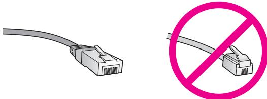
Aunque la apariencia de los cables Ethernet estándar es similar a la de los cables telefónicos normales, no son intercambiables. Cada uno tiene un número de hilos diferente, y el conector también es distinto. El conector de un cable Ethernet (denominado conector RJ-45) es más ancho y más grueso, y siempre tiene 8 contactos en el extremo. Un conector telefónico tiene entre 2 y 6 contactos.
