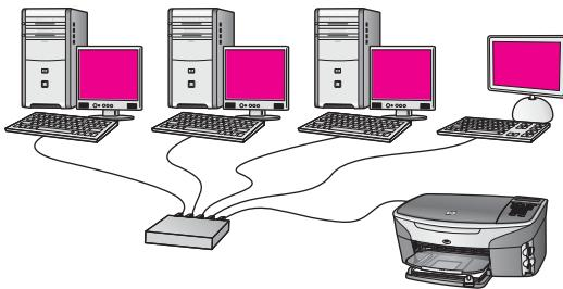
Neste exemplo, os dispositivos de rede são conectados a um switch ou roteador e não há conexão com a Internet. Dispositivos utilizam AutoIP, o que significa que os endereços de IP são configurados automaticamente. Se possuir esta configuração, conecte o HP all-in-one ao switch ou roteador com um cabo Ethernet. Para instruções sobre conexão, consulte [Como conectar com um cabo Ethernet](#).
