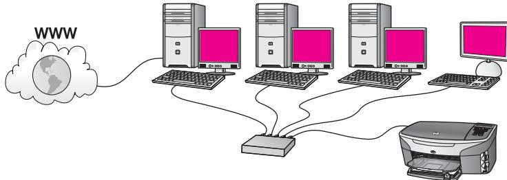
Neste exemplo, os dispositivos de rede são conectados a um switch ou roteador. Um computador na rede atua como gateway entre a rede e a Internet. O computador gateway usa o compartilhamento de conexão Internet (ICS) do Windows, ou um software similar, para gerenciar as conexões de rede e fornecer acesso à Internet à outros dispositivos.
