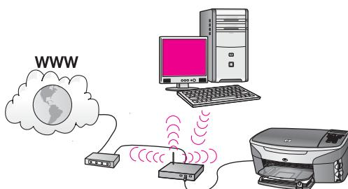
El punto de acceso conecta un dispositivo cableado a una red inalámbrica. El equipo está configurado para una red inalámbrica mediante un adaptador de red inalámbrica, y transfiere y recibe datos a través del punto de acceso. El HP all-in-one está configurado para una red cableada y se conecta al punto de acceso mediante un cable Ethernet. Un módem DSL o de cable puede proporcionar acceso a Internet. Para obtener instrucciones de conexión, consulte la sección [Conexión con un cable Ethernet](#).
